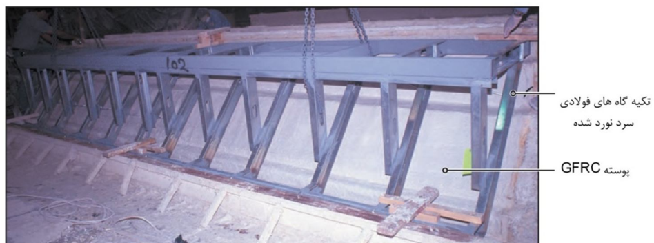
شکل ۶-۴۲- پس از متراکم کردن مخلوط ریخته شده، تکیه گاه فولادی سرد نورد شده در مقابل قالب قرار داده می‌شود
