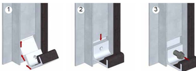
شکل ۷-۱۲- نحوه نصب بست‌ها بر روی ریل
