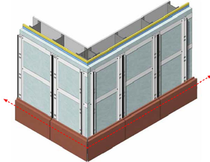
شکل ۷-۱۵- کنترل تراز بودن پنل‌ها
