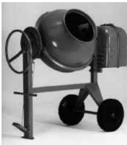
شکل ۴- بتونیر با محور متحرک با ظرفیت ۱۳۰ لیتر
