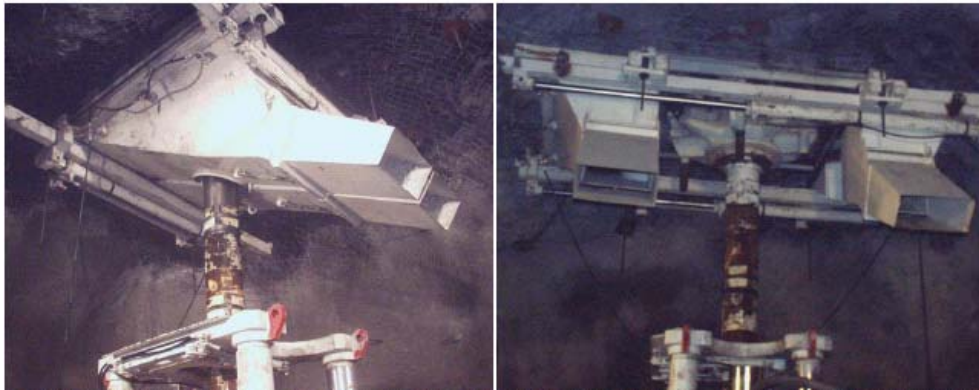
شکل ۳-۲۰-۳- نمایش دو نمونه قیف تخلیه کننده‌های حفاری
