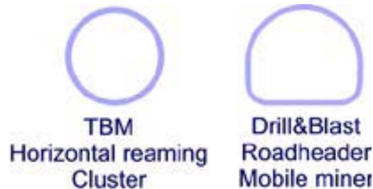
شکل ۳-۲۳-۴- مقاطع قابل حفاری با انواع ماشین‌های حفاری
