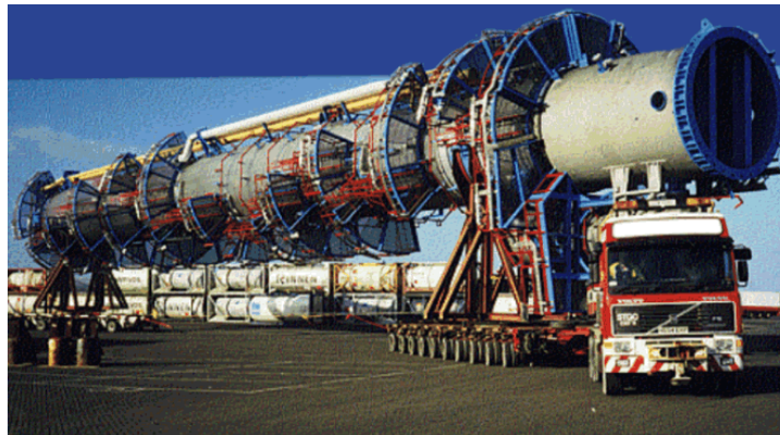
شکل ۶-۲-۱۲- بوژی ها ممکن است از چندین قسمت که نسبت به هم امکان چرخش دارند تشکیل شده باشد.
