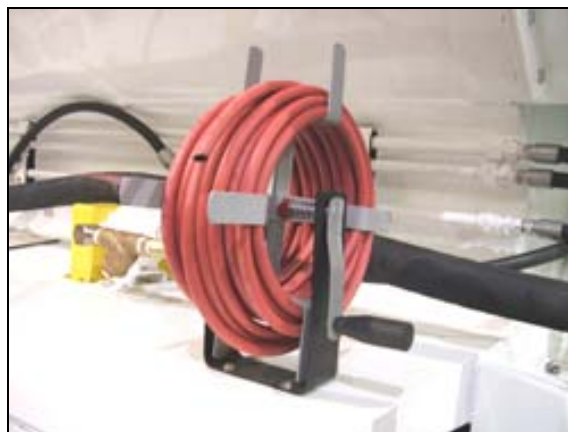
شکل ۳-۲۱-۱۱- لوله (شیلنگ) انعطاف‌پذیر برای خرج‌گذاری
