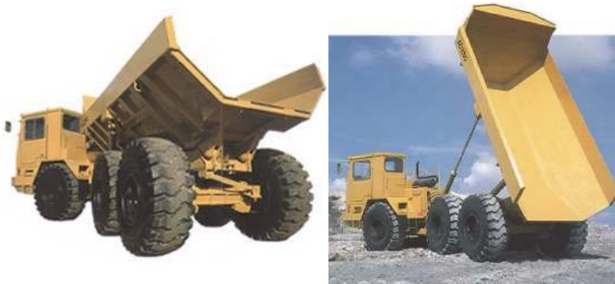
شکل ۲-۷-۵- کامیون کمرشکن در حال تخلیه
