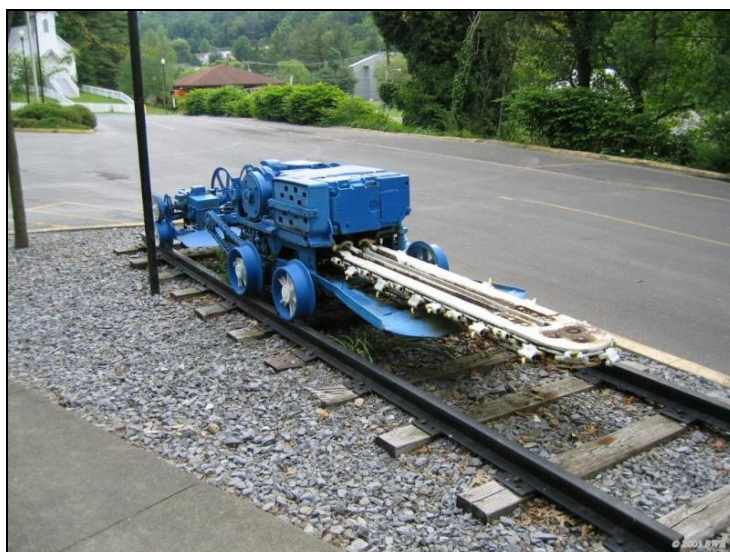
شکل ۳-۲۷-۵- نمونه هاواژ ریلی به کار رفته در معادن زغالی
