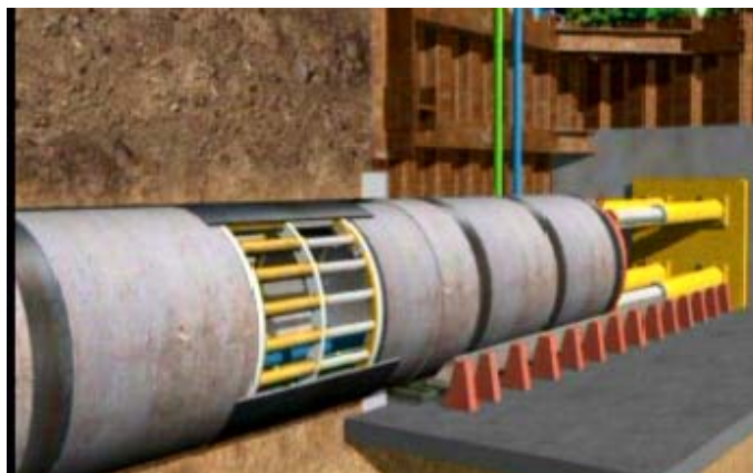
شکل ۵-۱۰-۹- ایستگاه جک های میانی
