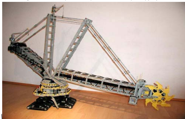
شکل ۳-۳۰-۱۱- این نوع اکسکویاتور بیل چرخشی در معادن روباز زغال در آلمان به کار می‌رود. این ماشین ۲۰۰ متر طول و ۱۰۰ متر ارتفاع دسترسی و توان استخراج روزانه ۳۰۰۰۰۰ متر مکعب زغال را داراست
