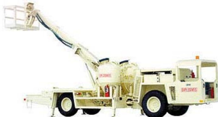
شکل ۳-۲۸-۱۰. نمونه دستگاه انفوشارژر، دارای سیستم محرکه، دکل و سبد
