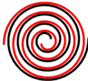
شکل ۶-۱۲-۷- نحوه عمل تراکم در کمپرسور Scroll
