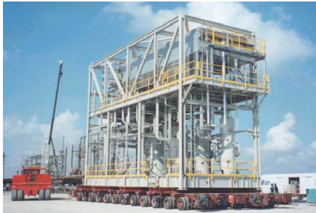
شکل ۶-۲-۷- حمل محموله بلند با بوژی بدون محدودیت در ارتفاع
