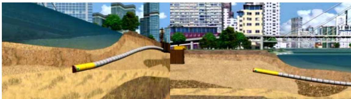
شکل ۵-۱۰-۲- نمایش مسیر لوله رانی از زیر رودخانه
