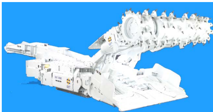
شکل ۳-۱۱-۴- Continuous Miner نوع Ripper
