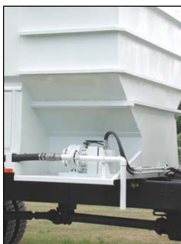
شکل ۳-۲۱-۱۳- پمپ انتقال گازوئیل
