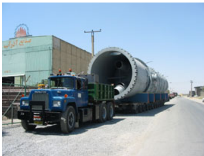
شکل ۶-۲-۱۴- استفاده از وزنه در انتهای بوژی کش برای کمک به شروع حرکت محموله
