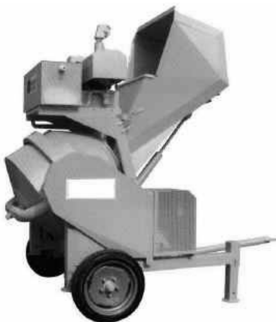
شکل ۴-۱۳-۵- بتونیر با محور متحرک دارای قیف تغذیه
