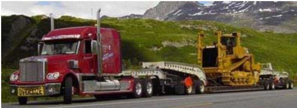
شکل ۳-۱۱-۶- حمل بلدوزر با کفی دارای شترگلو
