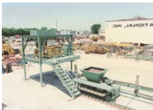
شکل ۵-۴-۱۳- دستگاه پوشش دهی داخلی با ملات سیمان
