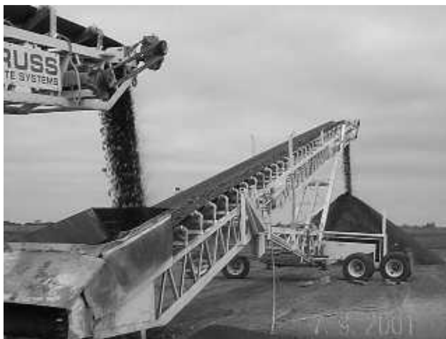
شکل ۴-۱۴-۳- تسمه نقاله‌ها سنگدانه‌های حاصل از بازیافت را به محل دپو منتقل می‌کنند
