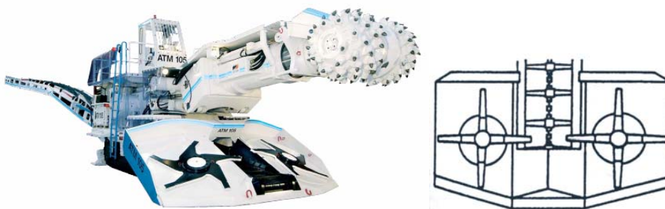
شکل ۳-۱۶-۱۴- ماشین رودهدر با صفحه پره دوار
