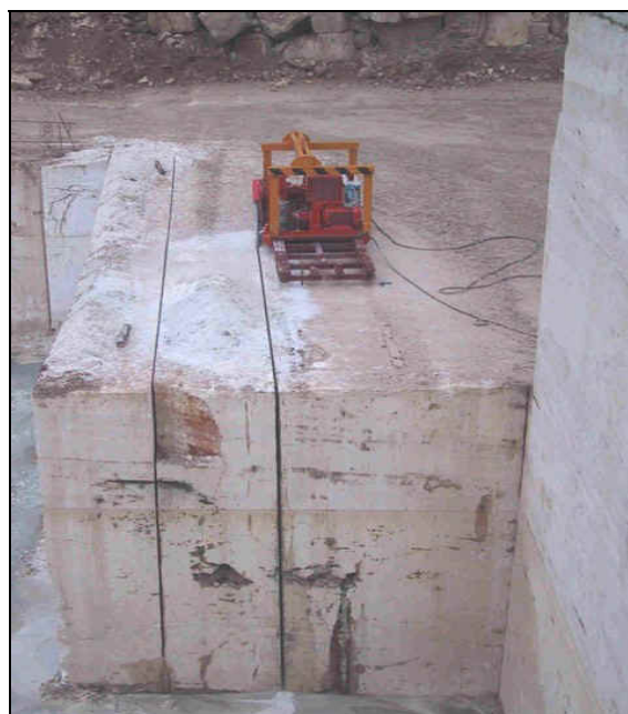
شکل ۳-۲۷-۳- استفاده از ماشین هاواژ در ایجاد برش اولیه
