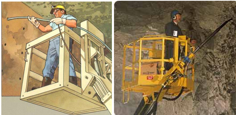
شکل ۳-۲۸-۱۱ خرجگذاری از داخل سبد دستگاه آنفوشارژر
