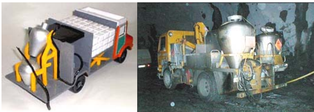
شکل ۳-۲۸-۸. نمونه دستگاه انفوشارژر، نصب شده روی کامیون
