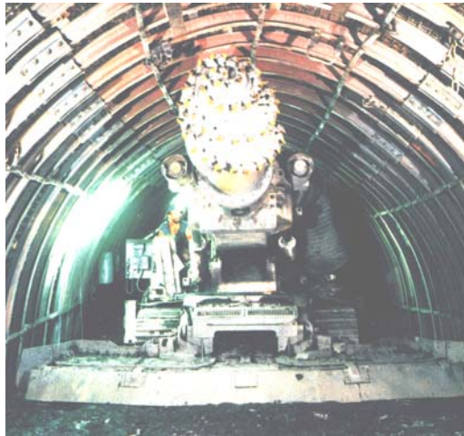
شکل ۳-۱۶-۳- ماشین روده‌در با برش محوری
