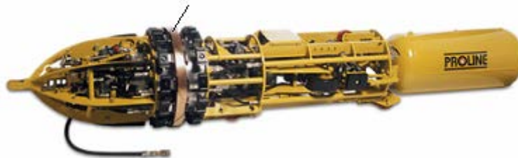
شکل ۵-۵-۴- کلمپ داخلی با صفحه کمکی مسی
