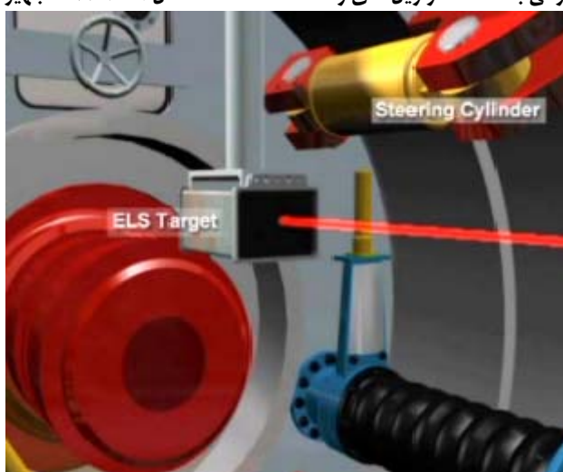
شکل ۹-۶-۱۵- کنترل مسیر توسط اشعه لیزر
