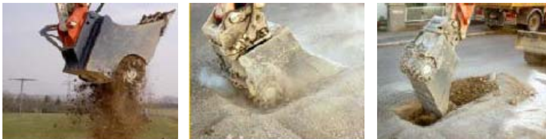
شکل ۳-۵-۲- سیکل کاری ماشین (الف) حفاری (ب) برش (ج) خردایش
