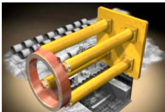
شکل ۵-۱۰-۸- سیستم جک زنی
