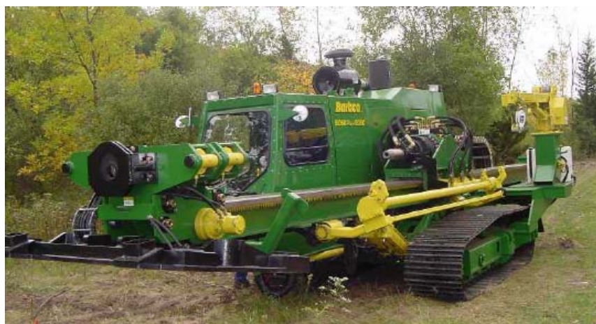
شکل ۳-۲۹-۱۳- دستگاه حفاری چالهای افقی
