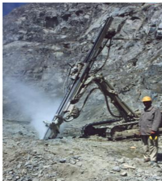
شکل ۳-۱۵-۲- دریل واگن چرخ زنجیری
