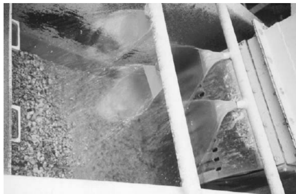
شکل ۴-۱۴-۵- جداسازی سنگدانه‌ها از بقیه مخلوط توسط فشار آب و ویبره
