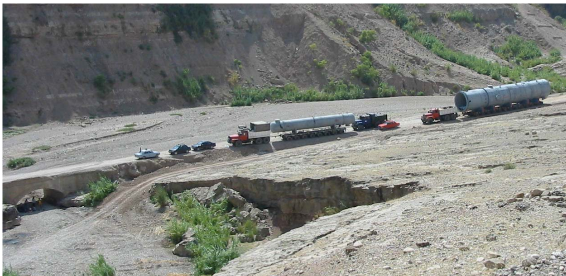
شکل ۶-۲-۱۰- عبور بوژی از کنار گذر پل
