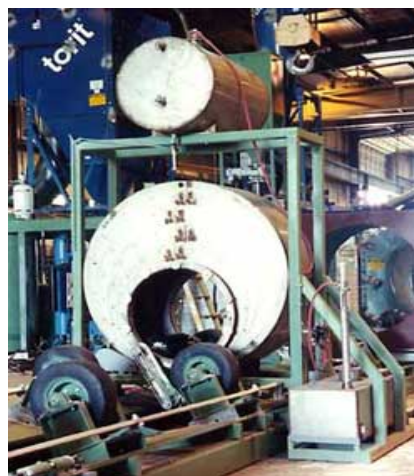
شکل ۵-۴-۱۰- سیستم پوشش دهی خارجی چند لایه
