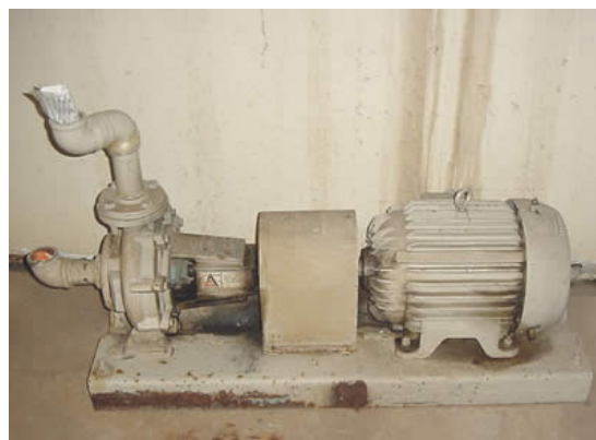
شکل ۶-۱۱-۳- یک پمپ سانتریفوژ متصل به الکتروموتور
