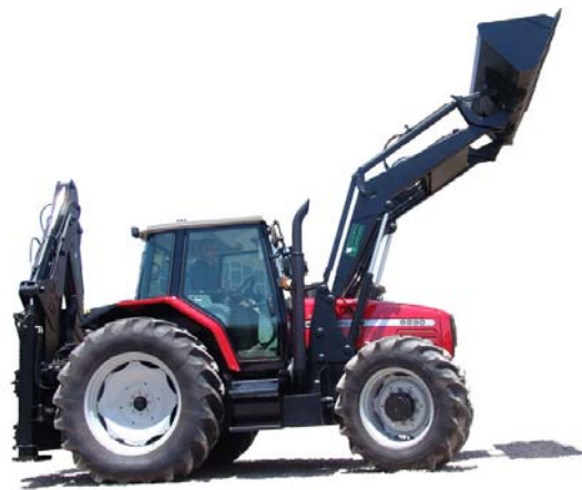
شکل شماره ۲-۹-۶- بکهو لودر کشویی هیدرولیکی
