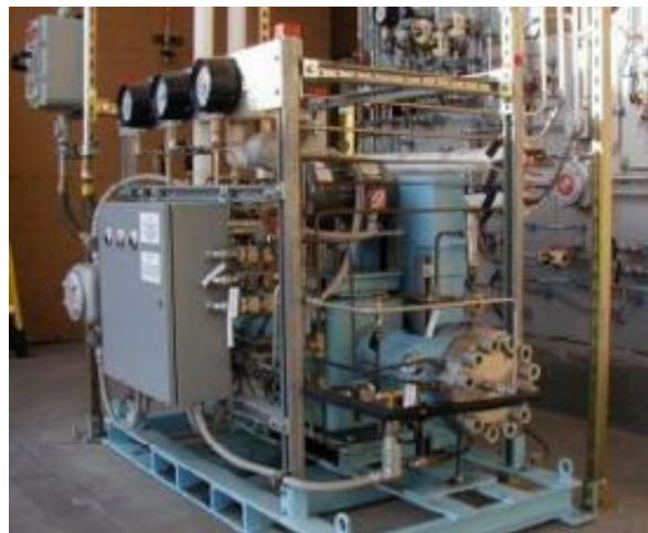
شکل ۶-۱۲-۵- کمپرسور دیافراگمی ۳ مرحله‌ای که CNG را تا ۶۰۰۰ psi (۴۱ مگاپاسکال) متراکم می‌کند.
