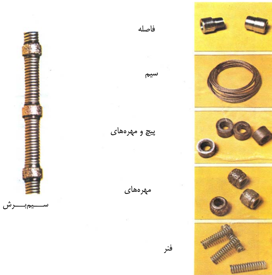
شکل ۳-۱۷-۸- قسمتهای مختلف سیم برش الماسه
