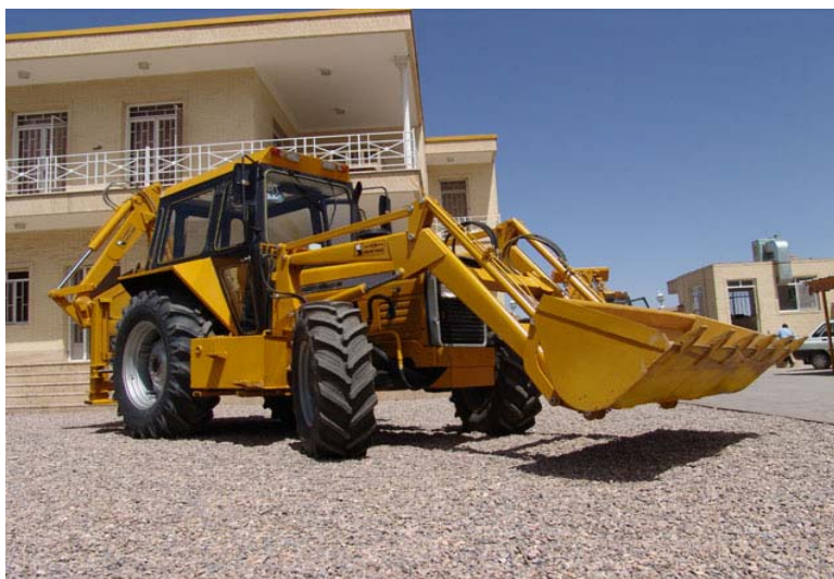
شکل شماره ۲-۹-۵- بکهو لودر کشویی مکانیکی
